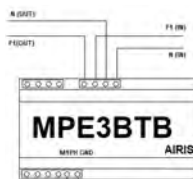
Conexionado Módem monofásico
